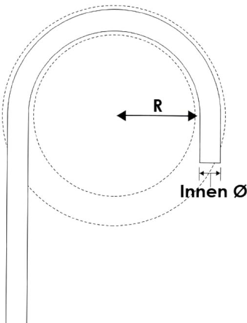
**Biegeradius:** „R“ ist der Strahl vom kleinstmöglichen Kreis in dem der Schlauch gebogen werden kann, ohne zu knicken.
